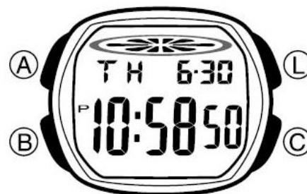
На рисунке изображен общий вид часов в Режиме Текущего Времени. Нажмите кнопку “B” для перехода из разряда в разряд в следующей последовательности:
